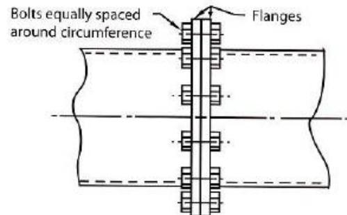
FIGURE 13 . FLANGED JOINT
