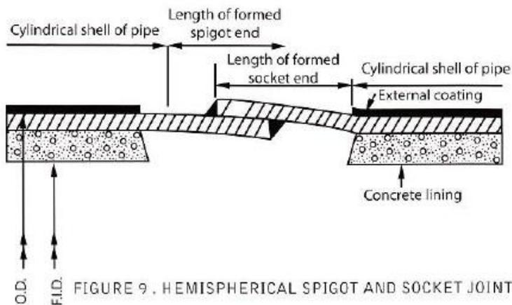
FIGURE 9 . HEMISPHERICAL SPIGOT AND SOCKET JOINT
